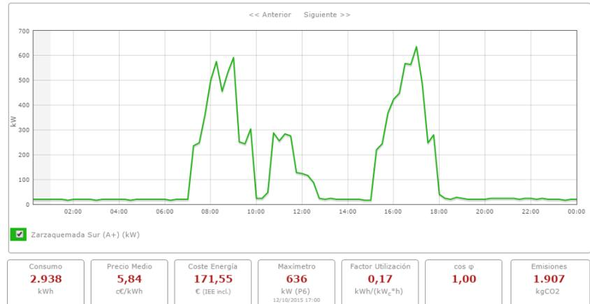
Haciendo funcionar los grupos secuencialmente en lugar de simultáneamente, el consumo de energía sigue estando en torno a los 3.000 kWh/día. Sin embargo la demanda de potencia baja hasta los 360kW, pudiendo aprovecharse este potencial ajustando la potencia contratada.
