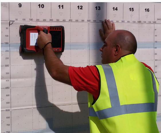
Escaneo de una estructura
